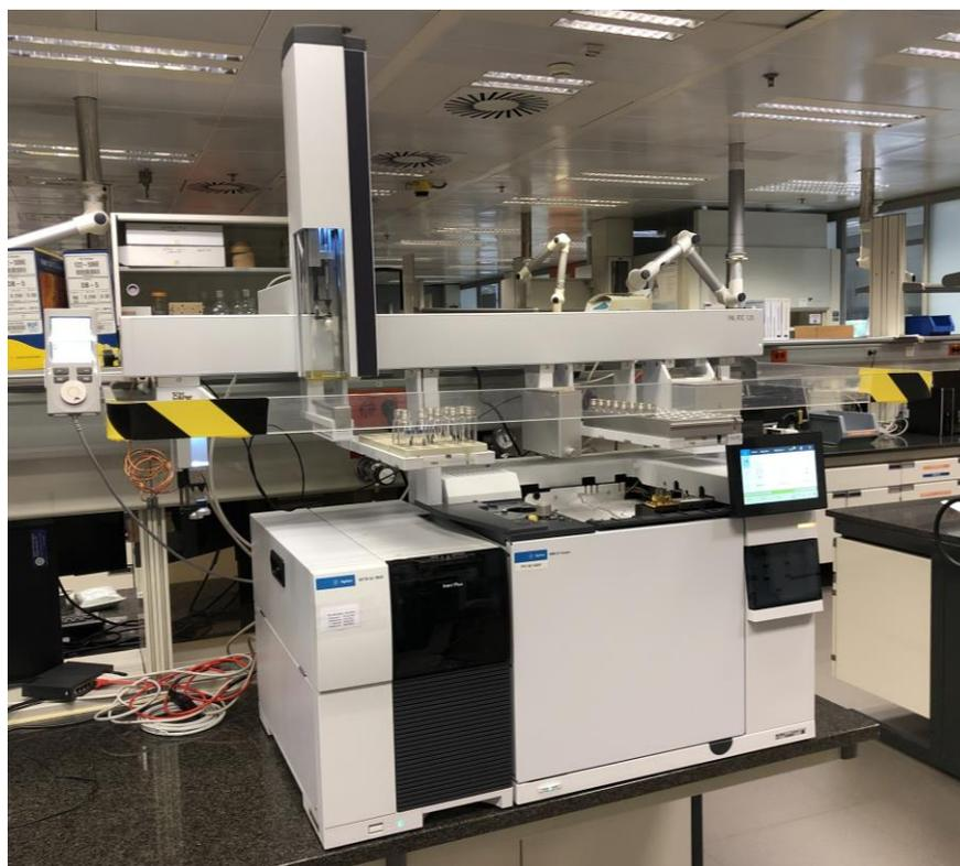
**Figura 7.** Fotografía del cromatógrafo de gases Agilent 8890 GC System (derecha) conectado a un espectrómetro de masas Agilent 5977B GC/MSD (izquierda). En la parte superior del equipo se observa un muestrador automático Combi PAL RTC 120 de CTC Analytics.
