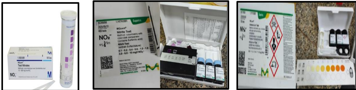
Figura 16: los test colorimétricos para las concentraciones de amonio, nitratos y nitritos
