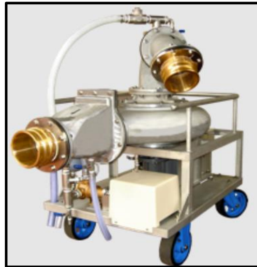
Figura 14: bomba de transferencia de peces vivos
