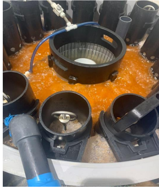
Figura 3: Dispositivo separador y cosechador de artemia a base de los imanes y luz
