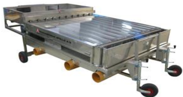
Figura 10: clasificadora de anchuras de alevines
