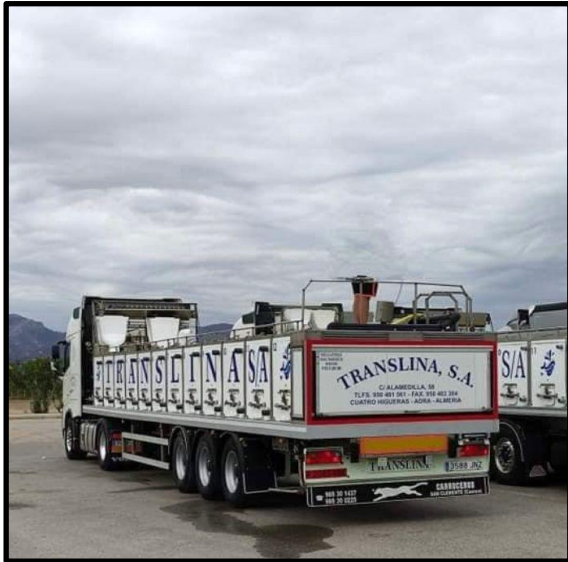
Figura 13: Camiones con cubas para transporte los peces equipados con sondas y difusores de oxígeno
