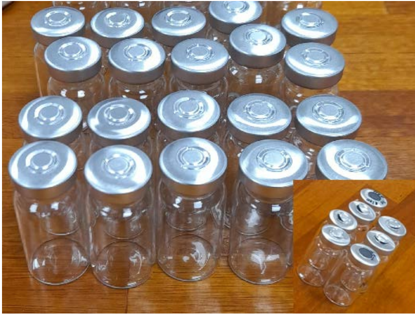
Figura 4-7: viales de 10 ml al vacío, con tapones de butilo y precintos de aluminio.
