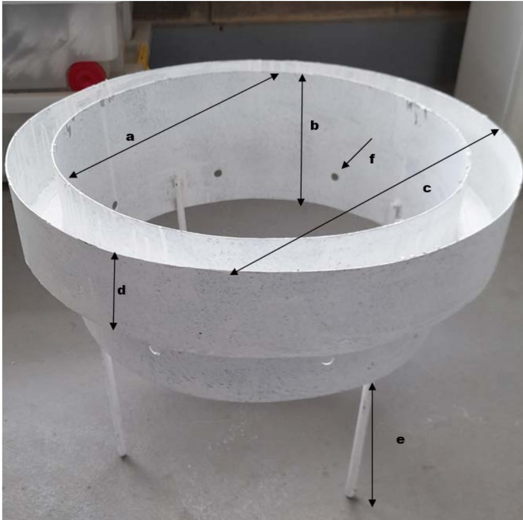
Figura 4-4: Diseño base metálica. Dimensiones: a) Cilindro interior, diámetro 35 cm; b) altura 15 cm. c) Cilindro exterior, diámetro 41 cm; d) altura 7 cm; e) 10 cm; f) perforaciones de 6 a 7 en el cilindro interior.
