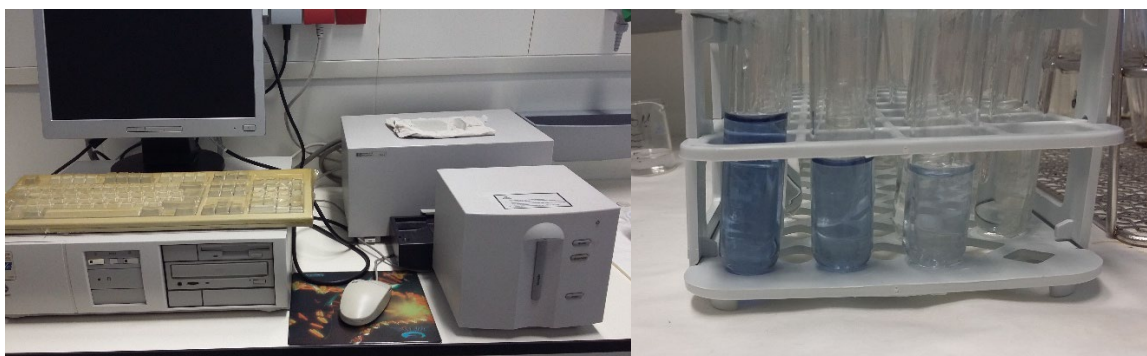
Figura 3: Espectrofotómetro UV- visible utilizado en los análisis (imagen izquierda), reacción del método de Grasshoff et al., en los análisis de fósforo (imagen derecha).
