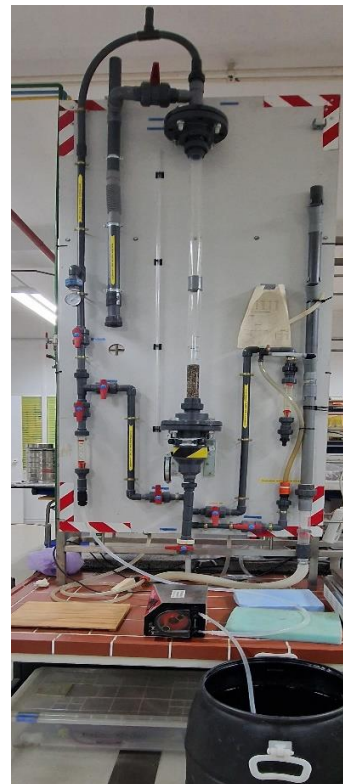
Figura 4-1. Esquema y foto del sistema experimental de columna de CTM de flujo continuo.
