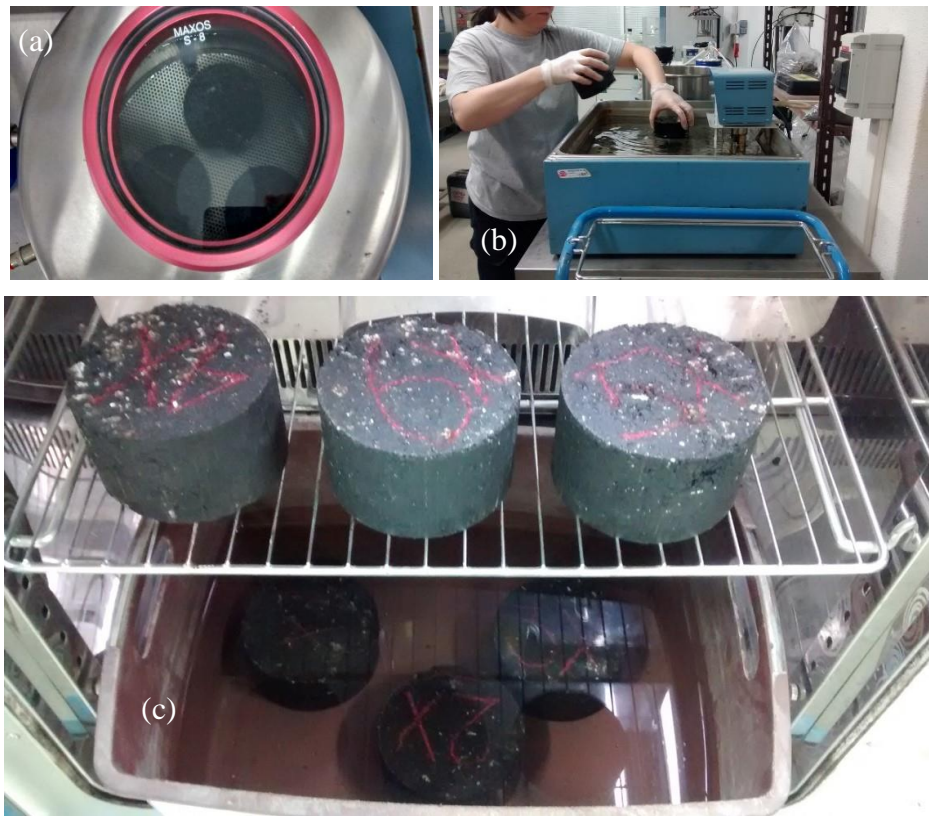
Figura 6 – Detalle del profesor y técnico de laboratorio durante la explicación de las prácticas: (a) acondicionamiento de las probetas del grupo húmedo, (b) inmersión de las probetas del grupo húmedo; (c) climatización de las probetas del grupo húmedo y seco antes de ensayo de resistencia a tracción indirecta
