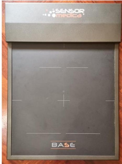
*Figura 13: Plataforma de presiones Sensor Medica SRL, Roma, Italia; controlador S/N: 130-220000132*
