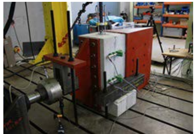
Figura 14. Montaje ensayo de tracción.
