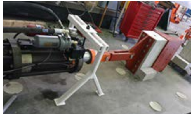
Figura 12. Probeta durante fisuración.
