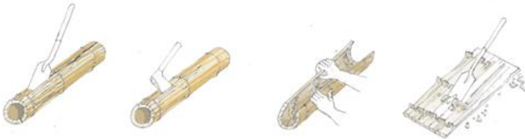
Fig. 74. Proceso para obtener esterilla de guadua. Fuente: Lucila Aguilar Arquitectos (s.f.)
