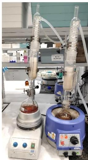
Figura 14. Montaje de extracción con Soxhlet.
