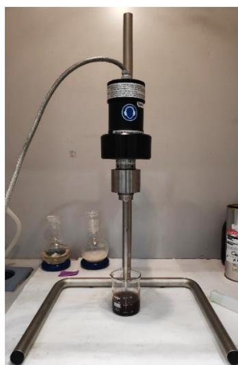
Figura 18. Montaje del ultrasonido de varilla.
