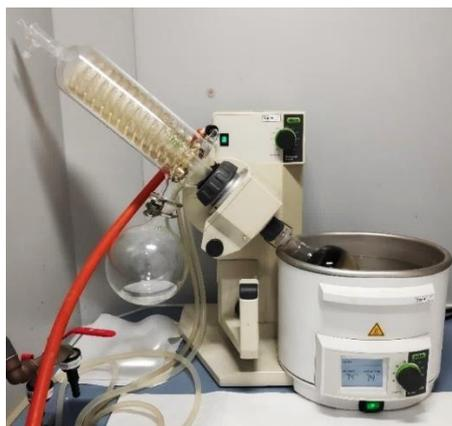
Figura 13. Eliminación del disolvente en el rotavapor.
