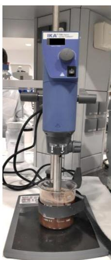
Figura 17. Montaje del ultraturrax.
