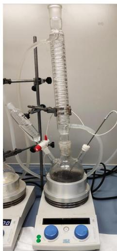
Figura 8. Montaje de reacción de epoxidación de la lignina.
