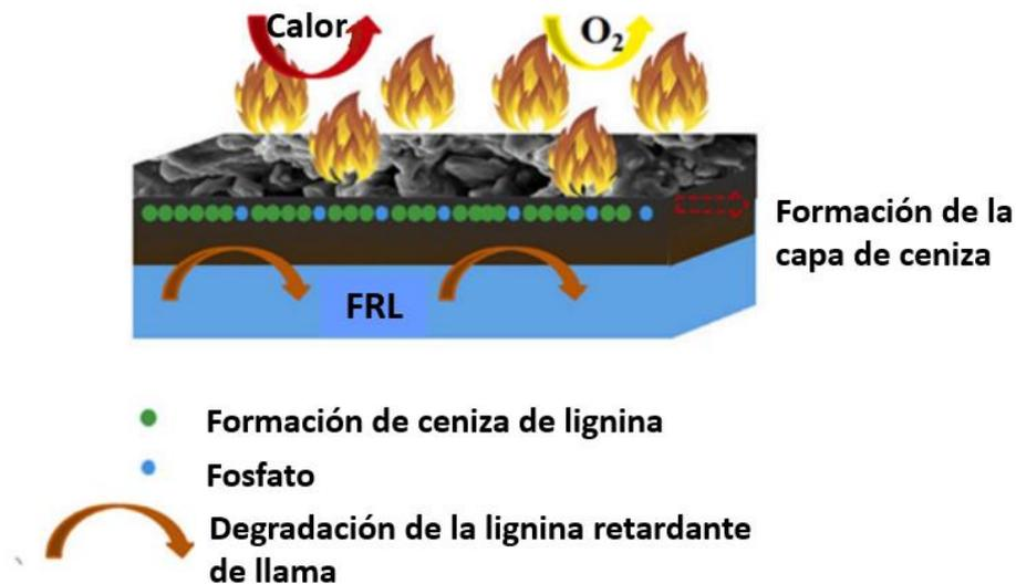
Figura 5. Representación del mecanismo de la lignina fosforilada como retardante de llama.<sup>14</sup>
