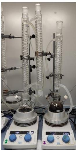
Figura 12. Montaje de reacción de fosforilación de la lignina.
