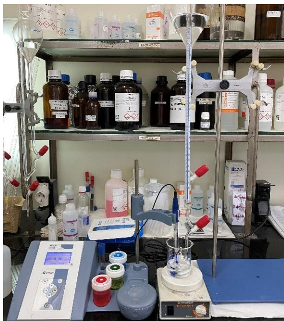
Imagen 4. Montaje realizado para determinar el índice de neutralización.
