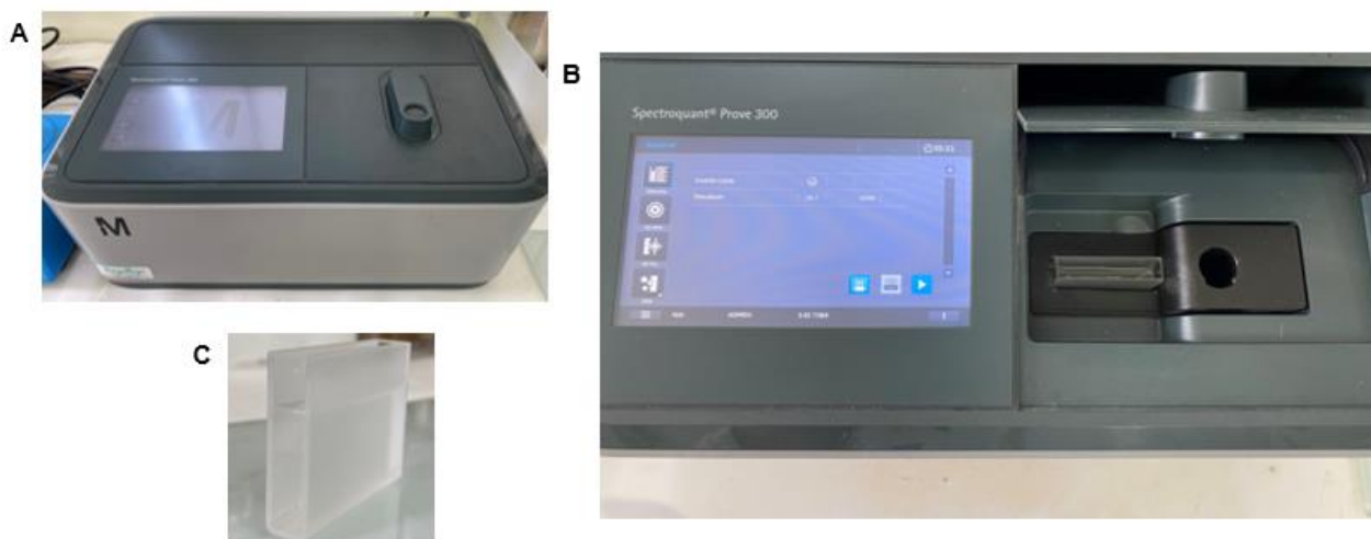
Imagen 7. A) Espectrofotómetro (marca Spectroquant Prove 300) utilizado en el laboratorio de Arteixo Química; B) Posición de la cubeta en el interior del espectrofotómetro; C) Cubeta de cuarzo utilizada.
