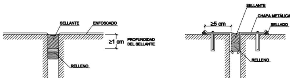
Figura 2.6 Ejemplos de juntas de dilatación
