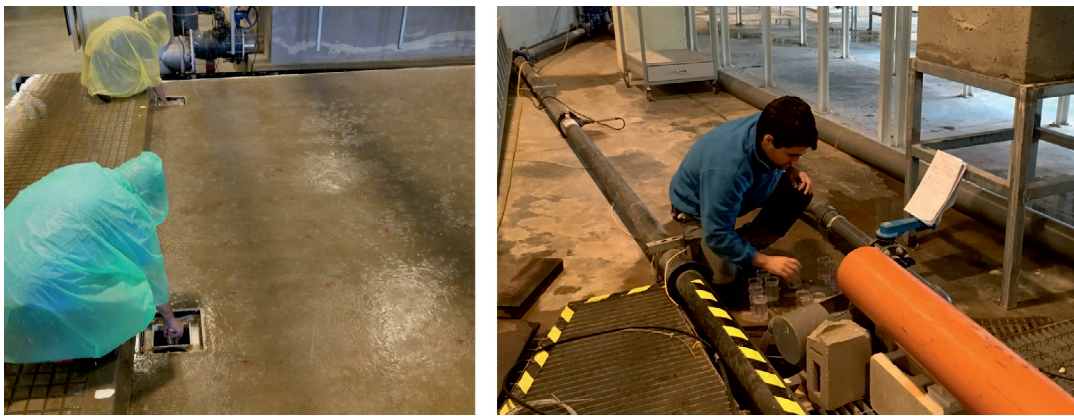
Figura 4 | Toma de muestras de manera manual en la entrada de las arquetas (izquierda) y en el punto de vertido de la red de colectores (derecha) durante los experimentos de lavado y transporte de sedimentos.
