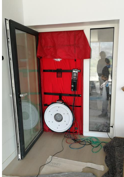
Ventilador test blowerdoor. Fuente: elaboración propia
