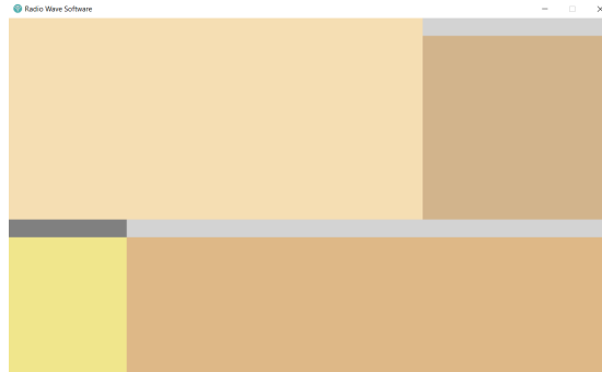
Figura 4.1: Delimitando nuestra interfaz gráfica en secciones mediante frames
