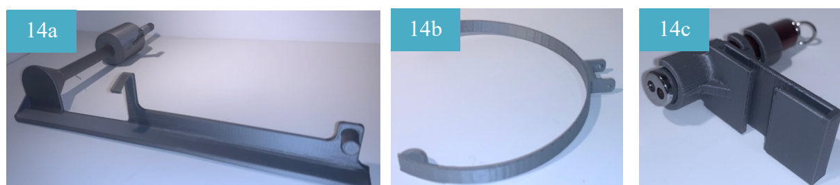
Figura 14. Composición del dispositivo portátil. 14a: primer soporte; 14b: segundo soporte; 14c: tercer soporte.
