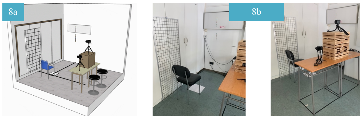
Figura 8. Disposición del set de medición fotogramétrico. 8a: esquema tridimensional; 8b: disposición real del set.
