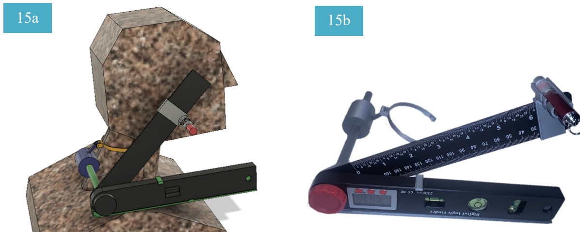
Figura 15. 15a: Prototipo de dispositivo portátil de medición de ACV. Autor: Dr. Florian Guy Bernard Michaud; 15b: dispositivo real.
