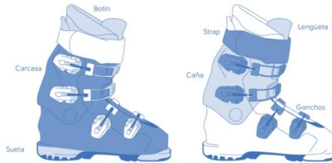
**Figura 1.** Partes de la bota de esquí (10)
