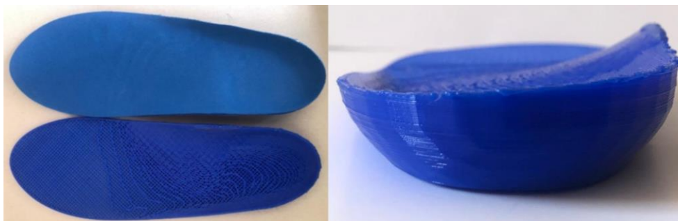
Figura 10: Ortesis impresas en 3D.
