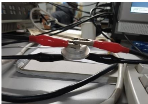
Figura 36. Montaxe experimental do supercondensador para a realización das medidas dieléctricas no Solartron 1260A Impedance/Gain-Phase Analyzer.
