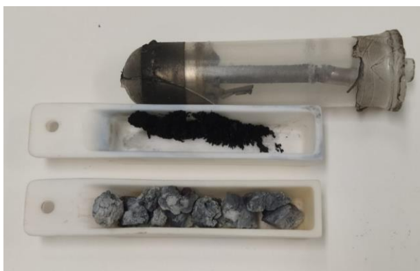
Figura 10. Aspecto do Ti (naveta inferior) e das HOIPs tras a calcinación (naveta superior). Observase que o polvo negro obtido das HOIPs ten un comportamento magnético.
