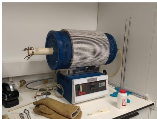
Figura 9. Forno tubular empregado para a obtención dos M@CNTs.
