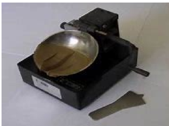
Figura 7. Máquina de Casagrande con la muestra de suelo (etapa 4 del procedimiento)
