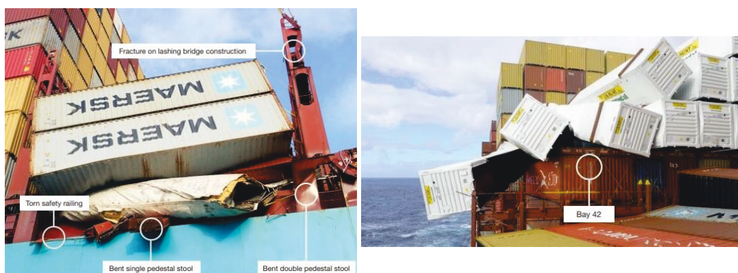
Figura 3: Daños resultantes del incidente (MAERSK A/S)
