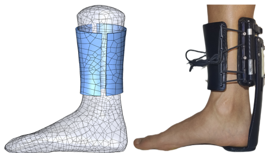
Figura 3: Malla escaneada del miembro del paciente, empleada como referencia durante el diseño CAD del modelo para su posterior fabricación.
