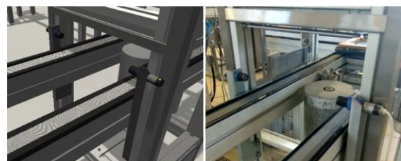
Figura 5: Comparativa entre el modelo 3D y el sensor de proximidad tipo barrera real.
