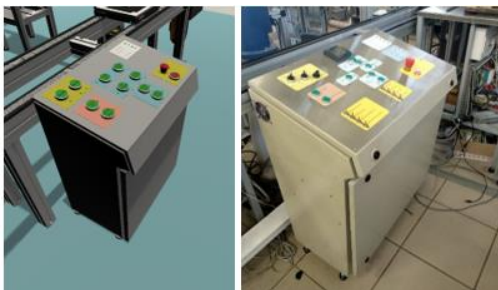
Figura 6: Comparativa entre el modelo 3D y el cuadro de mandos real.
