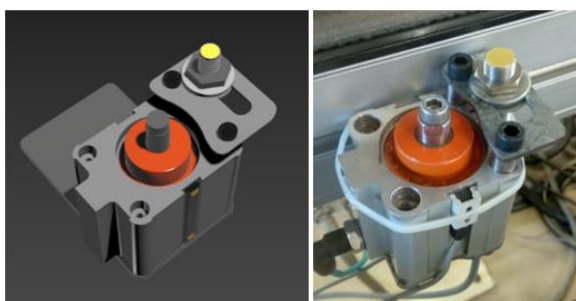
Figura 4: Comparativa entre el modelo 3D y el retenedor de bandejas real.
