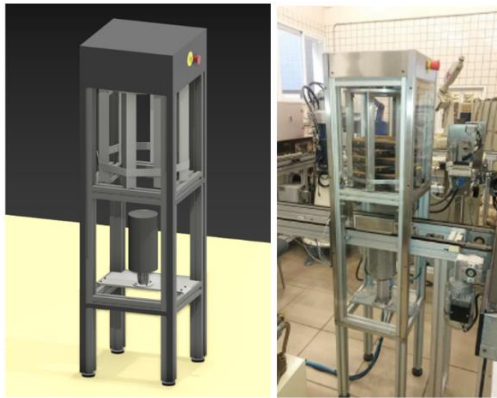
Figura 3: Comparativa entre el modelo 3D y el real del alimentador de bandejas.
