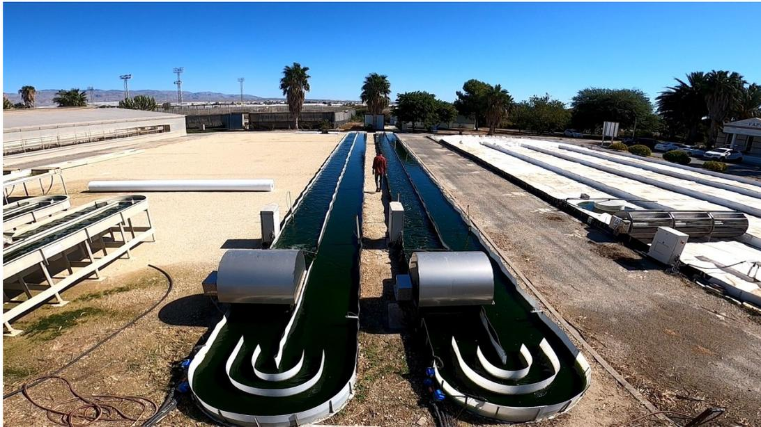
Figura 1: Fotobiorreactores *raceway* modelados en este trabajo.
