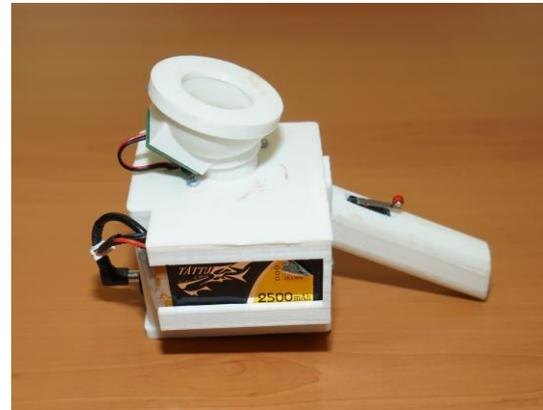
Figura 1: Imagen del sensor multispectral desarrollado.
