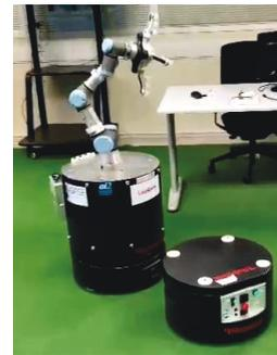
Figura 6: Comunicación entre dos robots móviles empleando la pasarela ROS/OPC UA
