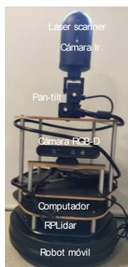
Figura 1. Plataforma de digitalización térmica.
