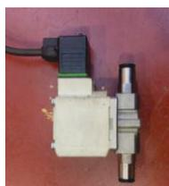
Figura 3 – Electroválvula utilizada para el control.
