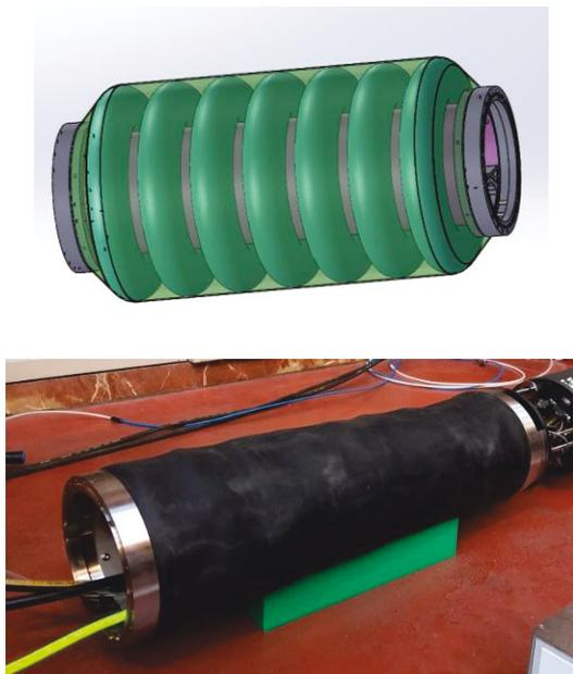
Figura 2 – Modelo CAD (arriba) y sistema real (abajo) del módulo de sujeción
