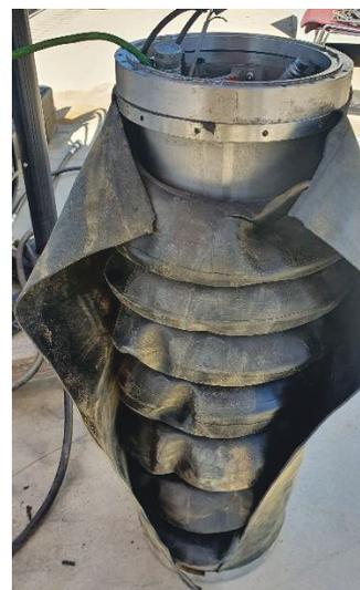
Figura 8 – Rotura del módulo de sujeción
