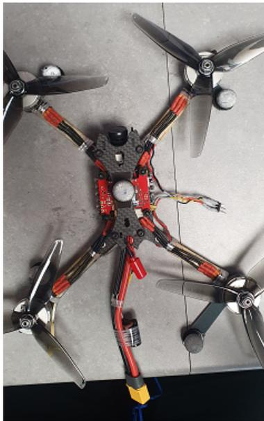
Figura 8: Ubicación de los marcadores en el dron de carreras.
