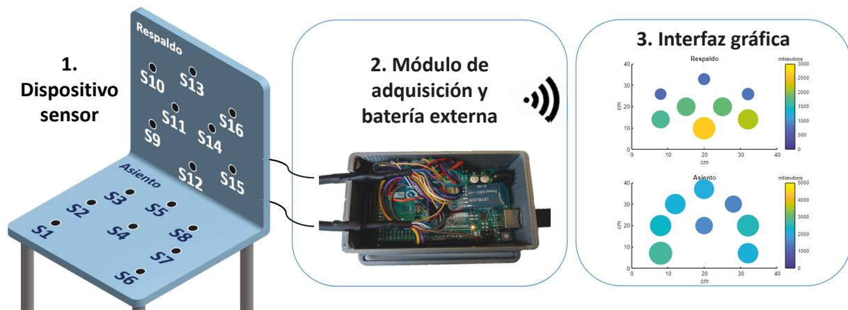
Figura 1: Módulos que componen el dispositivo de monitorización: 1- Dispositivo sensor con distribución de sensores. 2- Módulo de adquisición de datos. 3- Interfaz gráfica.
