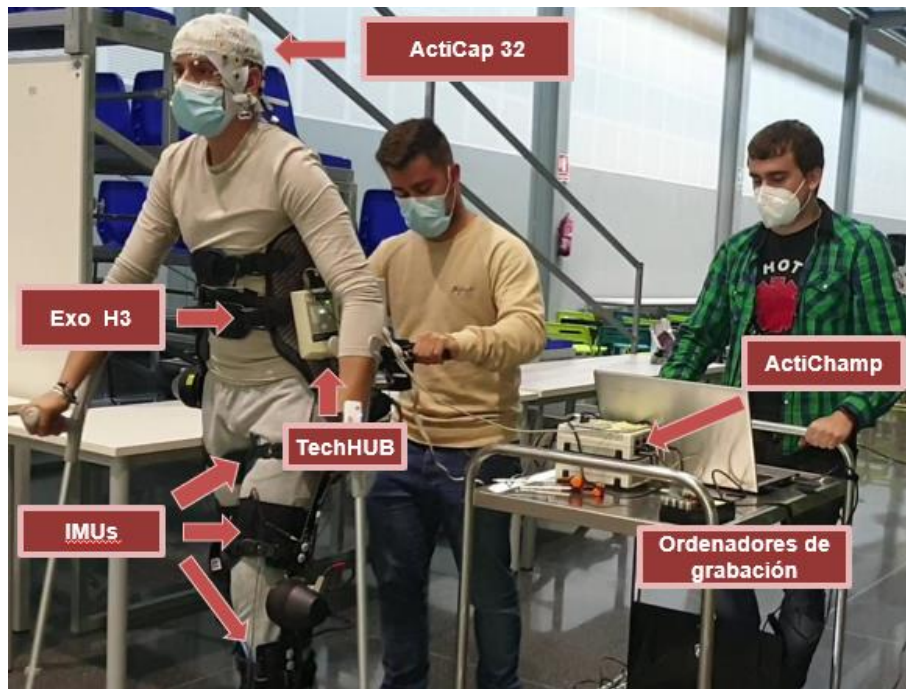
Figura 1: Instrumentación y equipos empleados durante los experimentos para el registro de señales EEG e IMUs.
