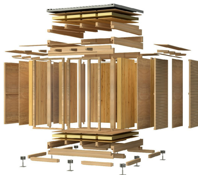
Figura 2. Despiece de los componentes del sistema UBUILD.
