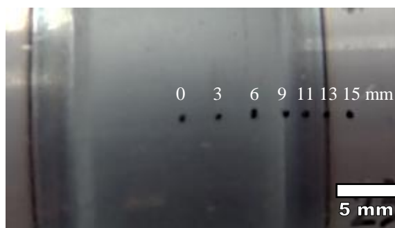
Figura 5.3. Detalle de la superficie tratada del ensayo realizado a 585 \text{ W/cm}^2 , donde se muestran de los puntos de medida de las tensiones residuales.
