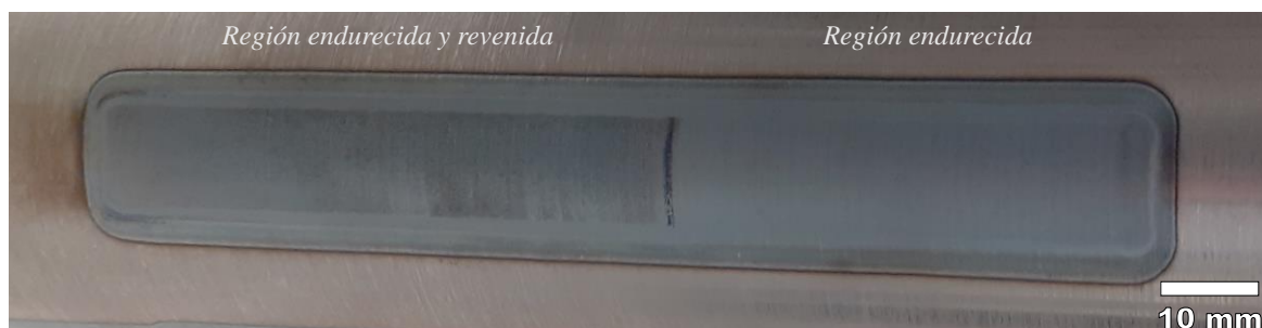
Figura 6.11. Apariencia exterior del tratamiento combinado de endurecimiento y revenido del ensayo A4 con R_{t-h} del 27 %.
