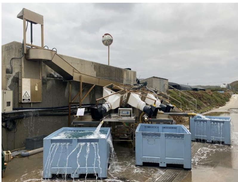
Figura 8. Máquina clasificadora en función del grosor y del tamaño. Fuente propia.
