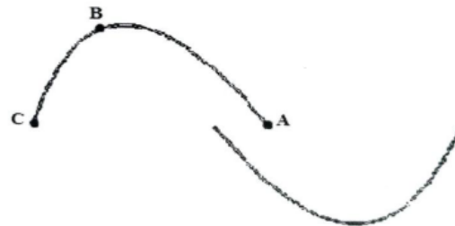
Fig. 2.5 Perfil de pala Kumar 50^\circ [48]
