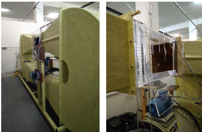
Fig. 12.2 Túnel de viento y detalle de sección de pruebas.
