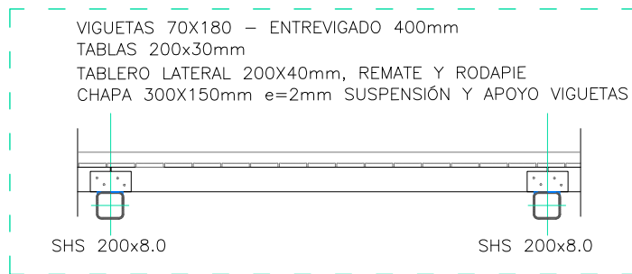
Sección longitudinal SL por pasarela, detalle unión rastreles 1:50
