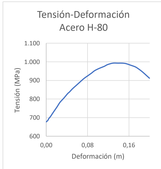
Gráfica 12 - Tensión-deformación teórico del acero H-80
