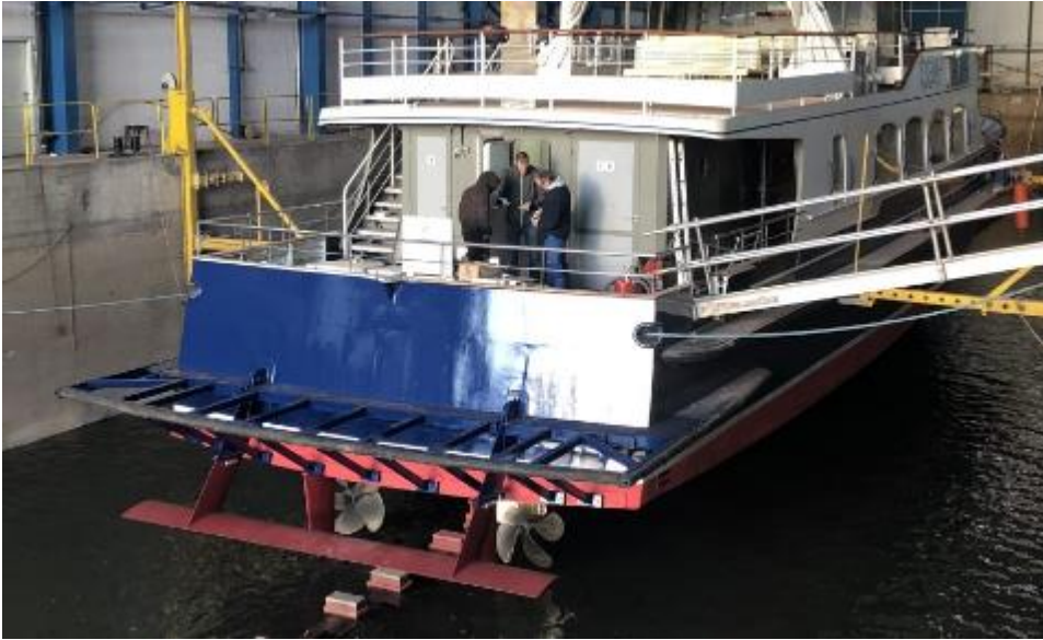
Ilustración 1 Interceptores de popa fijos en un barco de pasaje de 30 m de eslora. Extraído de: [1].
