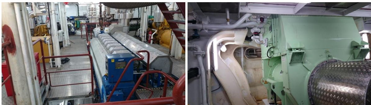
Figura 76. Motor propulsor (izquierda) y alternador de cola (derecha) de un buque atunero.
