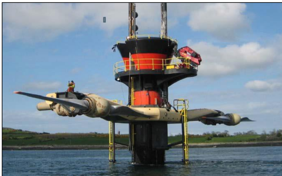
Figura 8. Dispositivo SeaGen S. Obtenido de (Jackson & Persoons, 2012).
