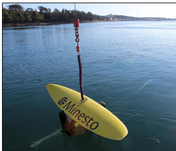
Figura 6. Dispositivo tipo kite tidal MINESTO (fuente tethys.pnnl.gov ).
