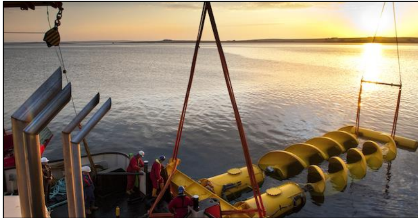
Figura 5. Dispositivo tipo tornillo de Arquímedes Flumill (fuente tethys.pnnl.gov ).
