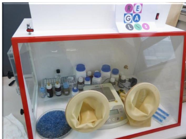
**Figura 4.0.1.** Cámara hermética con atmósfera de humedad controlada.
