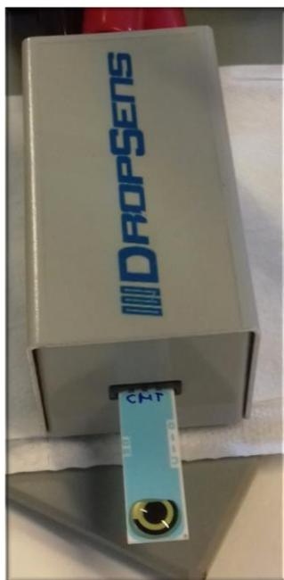
**Figura 4.6.4.** Conector de electrodos serigrafiados con un SPE.
