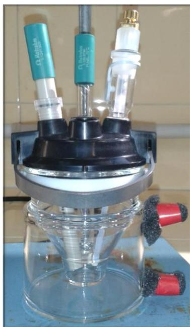
**Figura 4.6.8.** Celda electroquímica del laboratorio en la UDC.
