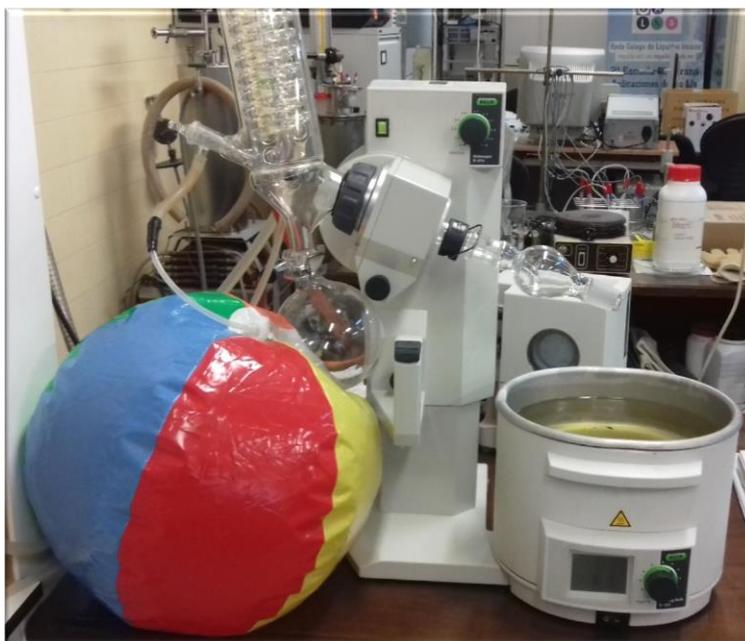
**Figura 4.0.5.** Equipo de secado con Rotavapor R-210 BUCHI.
