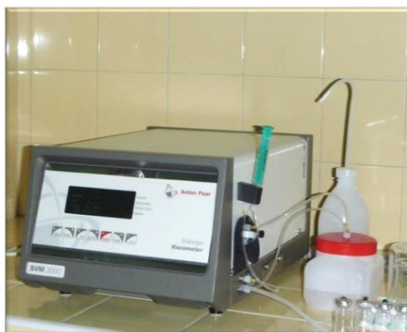
**Figura 4.1.1.** Viscodensímetro Anton-Paar Stabinger VTM 3000.
