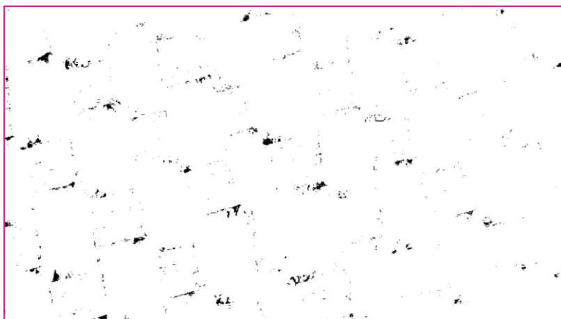
Figura 41 - Imagen tratada en binario para la muestra de Lyocell.
