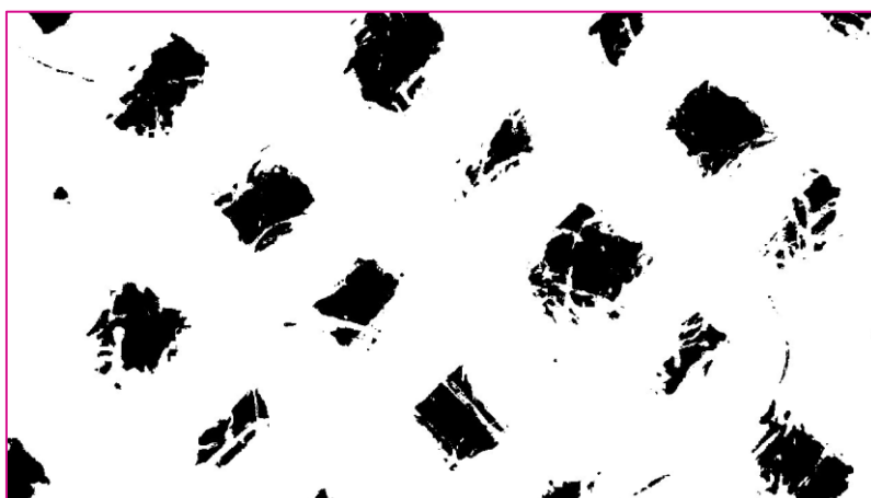
Figura 39 - Imagen tratada en binario para la muestra de algodón.
