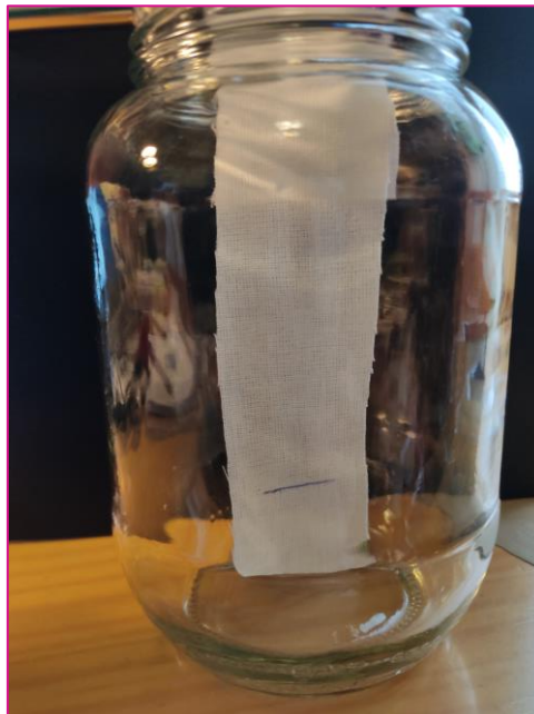
Figura 27 - Configuración del wicking test.
