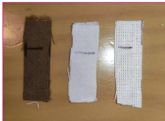
Figura 37 - Muestras de cada tejido para el cálculo de densidad (de izda. a dcha. lyocell, rayón y algodón).
