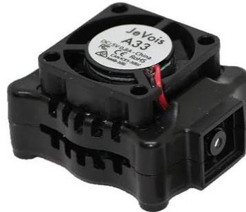
Figura 16. Cámara JeVois-A33. Fuente: [33]
