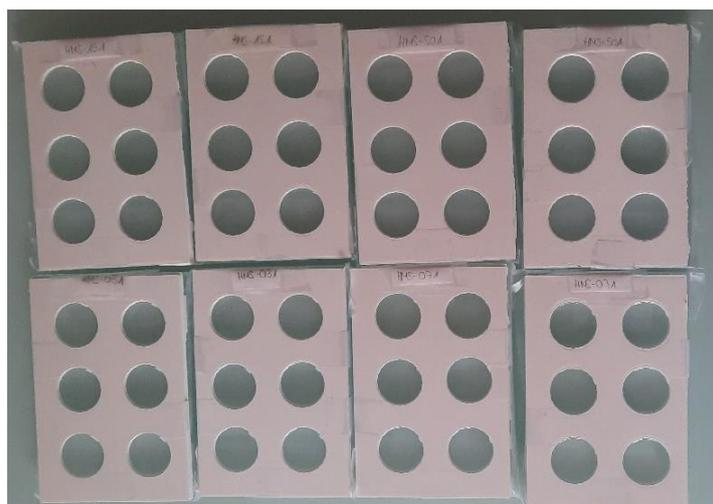
Figura 34. Moldes después de verter la silicona preparados para que comience el proceso de curado
