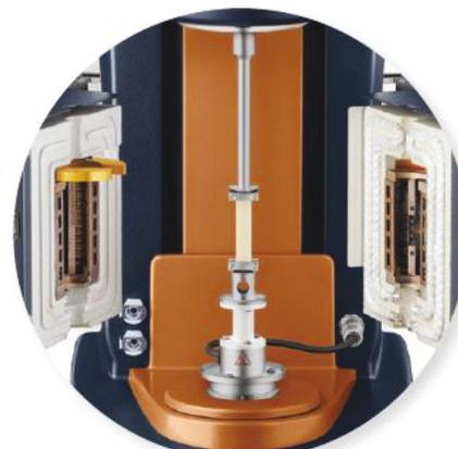
Figura 42. Cámara ambiental de ensayo (Reómetro DHR-2 TA Instruments)
