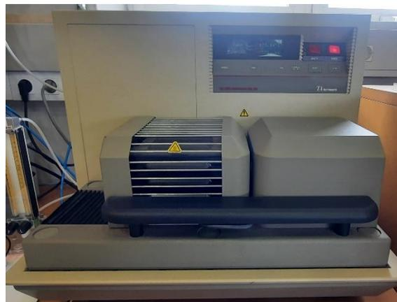
Figura 50. Analizador simultáneo cerrado (SDT 2960 de la marca TA Instruments)
