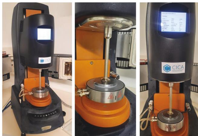
Figura 40. Reómetro de platos paralelos, DHR-2 TA Instruments
