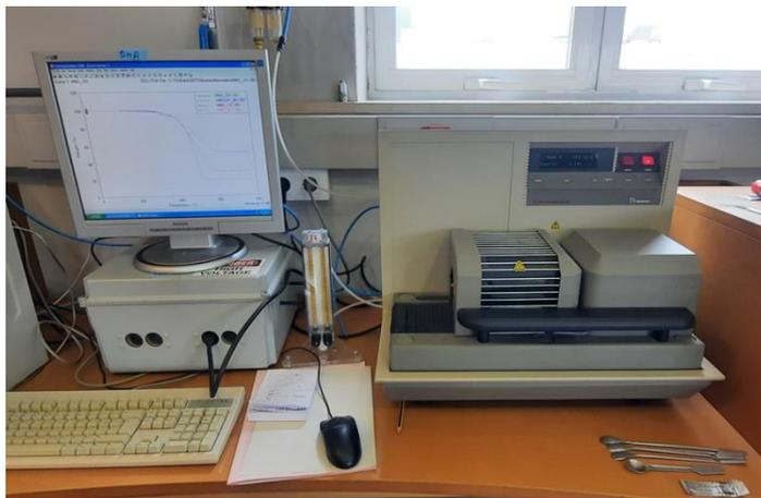
Figura 47. Analizador simultáneo SDT 2960 de la marca TA Instruments
