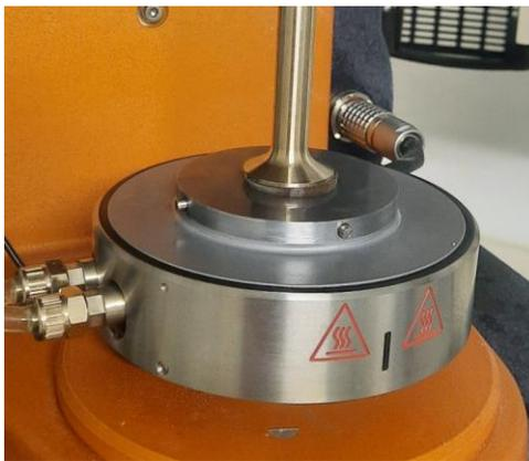
*Figura 46. Vista detalle platos del reómetro (Reómetro DHR-2 TA Instruments)*
