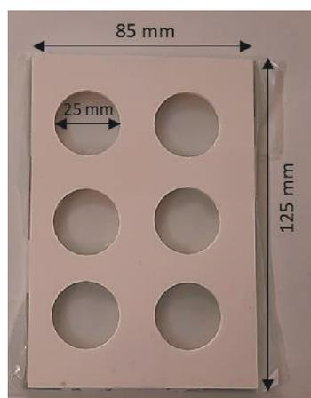
Figura 29. Molde 3D impreso para la preparación de las muestras
