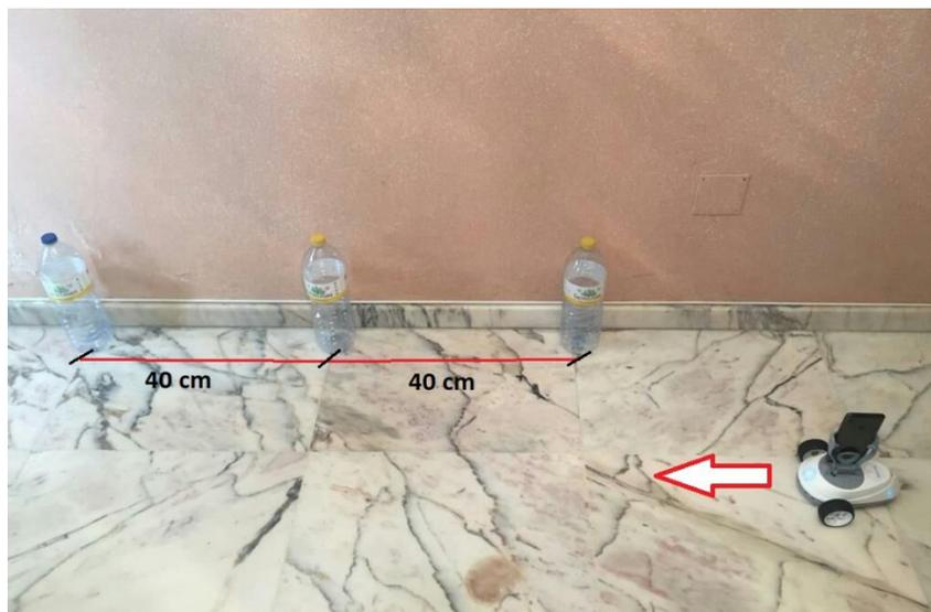
**Figura 45.** Esquema de las pruebas realizadas con el Robobo en movimiento.
