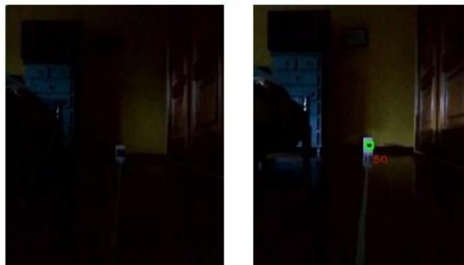
**Figura 83.** Marcador a 300 cm. Nivel de luz de izquierda a derecha: 3 y 5 Lux.
