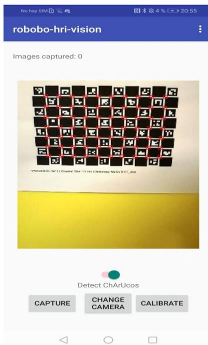
Figura 71. App de calibración del módulo de detección de ArUcos.
