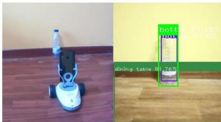
**Figura 23.** Ejemplo de vista externa (izquierda) y vista desde el Robobo (derecha) durante el proceso de detección de un objeto.
