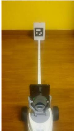
**Figura 78.** Robobo mirando de frente al marcador ArUco.
