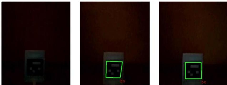
**Figura 82.** Marcador a 50 cm. Nivel de luz de izquierda a derecha: 3, 5 y 7 Lux.
