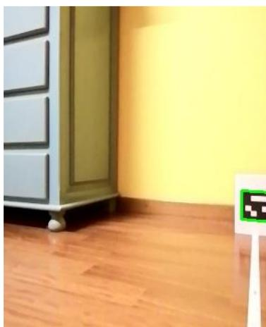
**Figura 80.** Marcador ArUco detectado con Pan 25, a 100 cm de distancia.
