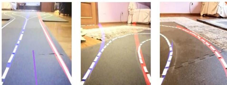
**Figura 55.** Tramos con distinta curvatura con los carriles pintados.
