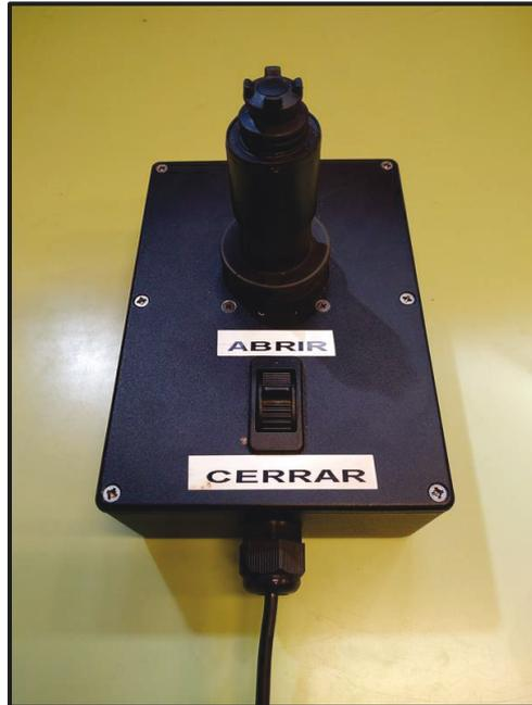
Figura 4-13. Joystick de control del Brazo TITANROB.
