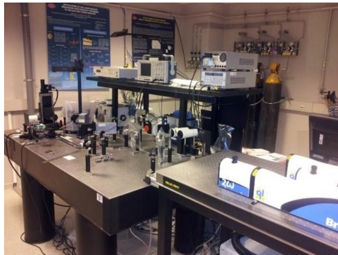
Figura 4.1: Fotografía del sistema experimental utilizado para LIBS
