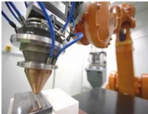
Figura 3.1: Cabezal del láser Nd:YAG acoplado al brazo robot y pieza con cordones de LC
