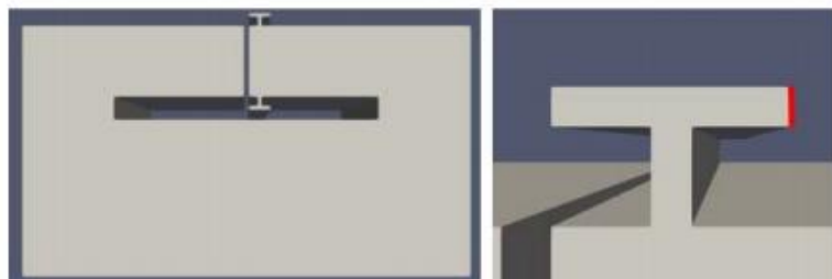
Figura 45: Modificacións xeométricas coas tomas de presión
