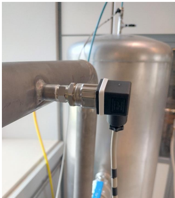
Figura 74 Nuevo transductor de presión estática estacionario aguas abajo de la placa de orificio con rango de presión 0 – 10 bar.
