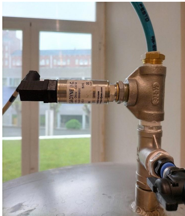
Figura 76 Transductor de presión estática estacionario en el depósito de 700 L.
