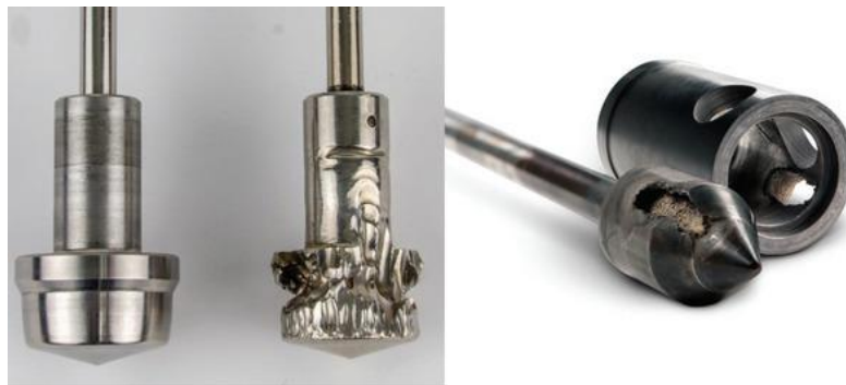
Figura 44 Daños materiales ocasionados por el fenómeno de la cavitación. AMS Steam Technology. Marc Manich.
