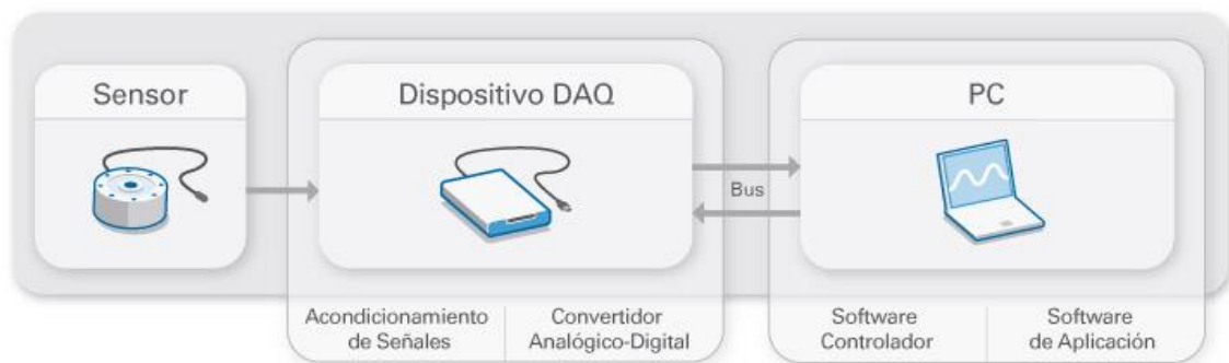
Figura 68 Partes de un sistema de adquisición de datos (DAQ). National Instruments.
