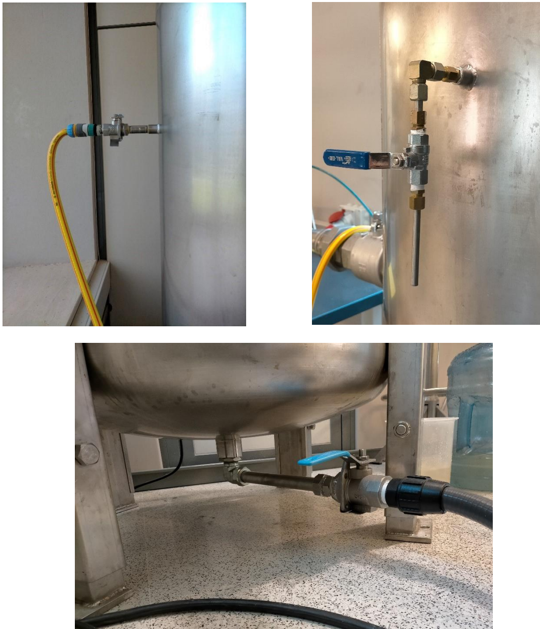
Figura 60 Sistema de llenado, ojo de buey y sistema de vaciado, por este orden.
