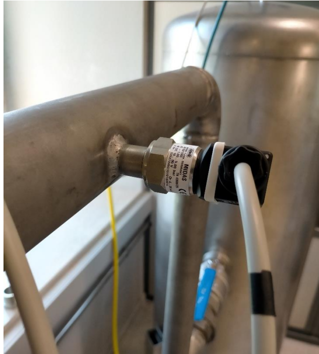
Figura 73 Transductor de presión estática estacionario aguas abajo de la placa de orificio con rango de presión 0 – 6 bar.
