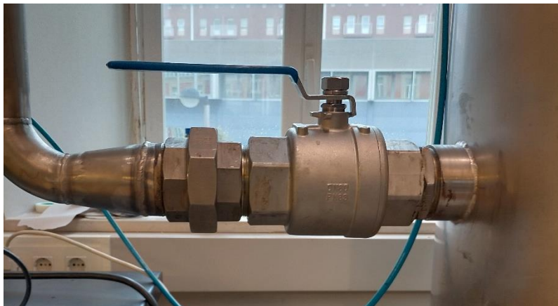
Figura 66 Válvula de estrangulamiento aguas abajo de la sección de pruebas totalmente abierta.
