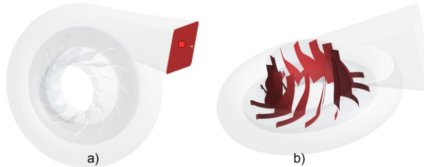
Figura 22. Designación de zonas de interés. (a), la entrada. (b), la superficie de los álabes.
